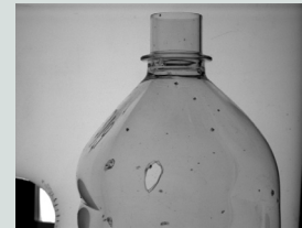
Löcher und Einschlüsse
