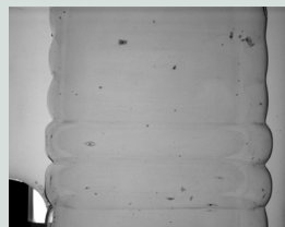
Kontureinfall und fehlerhafte Ausformung
